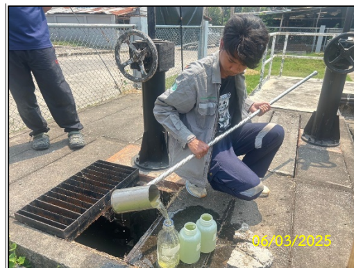
บ่อบักน้ำสุดท้ายก่อนระบายน้ำทิ้งลงสู่รางระบายน้ำ ของโครงการอาคารเช่าเดิม
